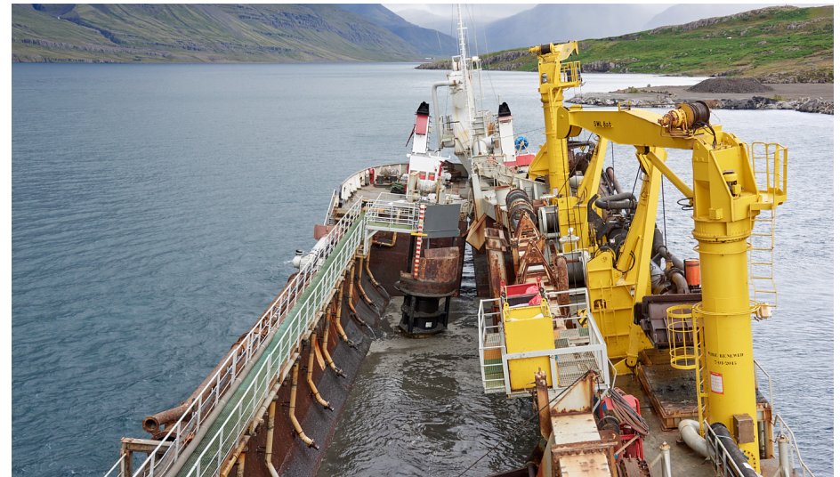
Mynd 2.5: Botninn á Galilei 2000 opnaður yfir öðrum stækkunaráfanga Mjóeyrarhafnar og efni sleppt. Þarna sést hvernig kjölurskipsins er opnaður þegar efni er sleppt í landfyllinguna.
